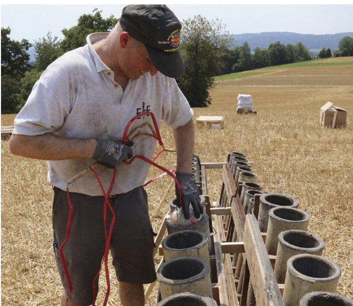
Die Abschussrohre werden nach vorgegebenem Plan mit den Bomben gefüllt.
